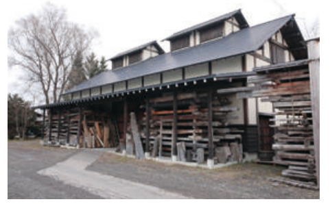
武部建設の古材ギャラリー。新築の注文を受ける際、古い家の解体も担うことが多いため、良い古材を引き取ってきて保管する。古民家再生や新築のアクセントとして使用する。
