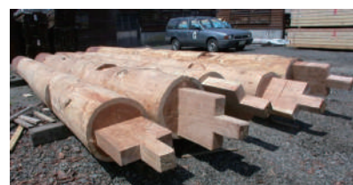
写真3 伐り出したカラマツを構造材に
